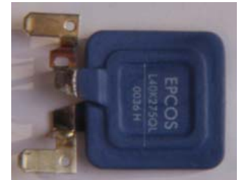
Erilaisten salamaiskujen taajuus Varistorin toiminta salaman eliminoinnissa Jokainen jännitepiikki lyhentää varistorin ikää
