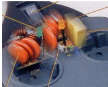
Erilaisten salamaiskujen taajuus Varistorin toiminta salaman eliminoinnissa Jokainen jännitepiikki lyhentää varistorin ikää
